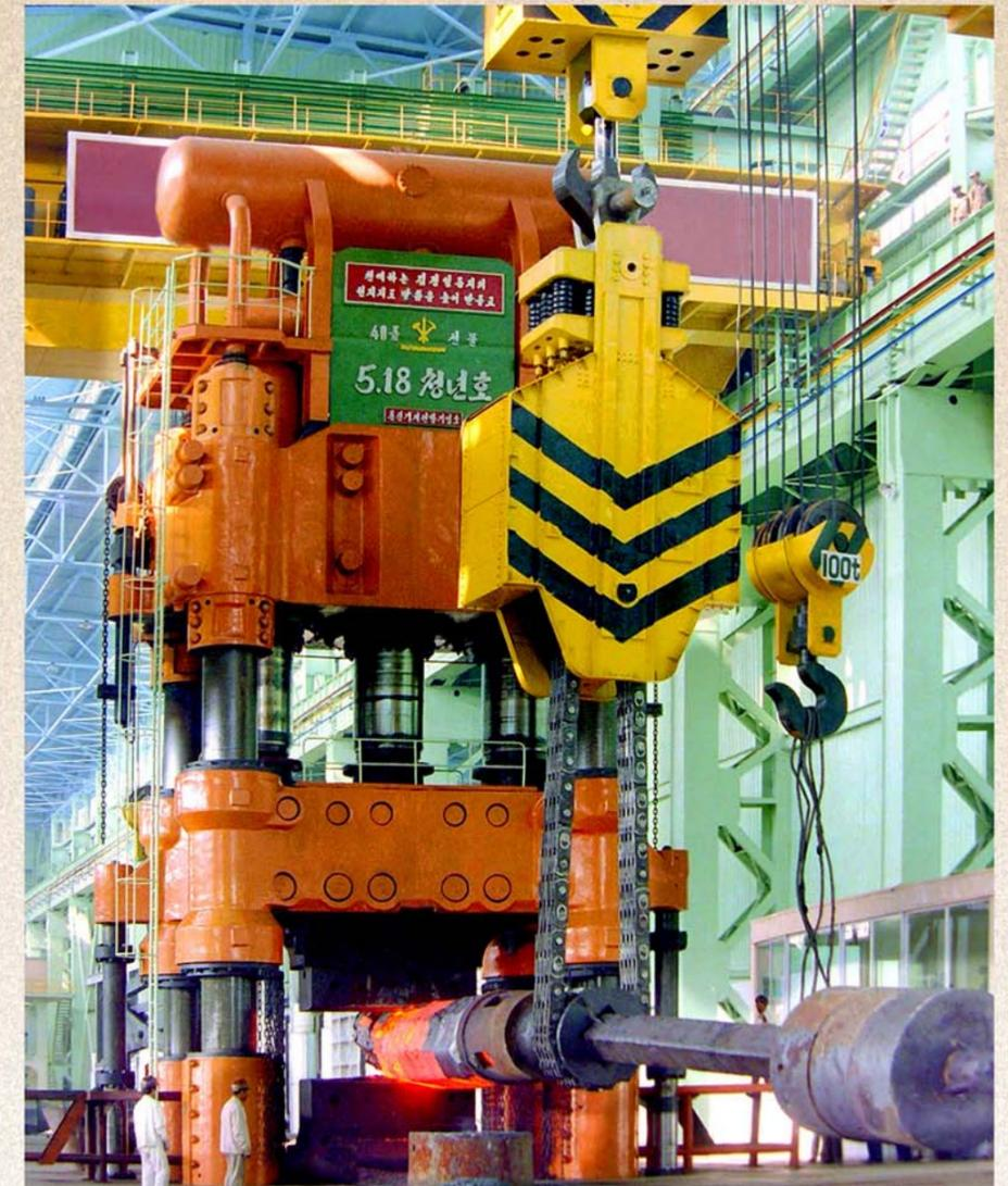
Пресс усилием 10 тыс. тонн, изготовленный рабочими Рёнсона.
