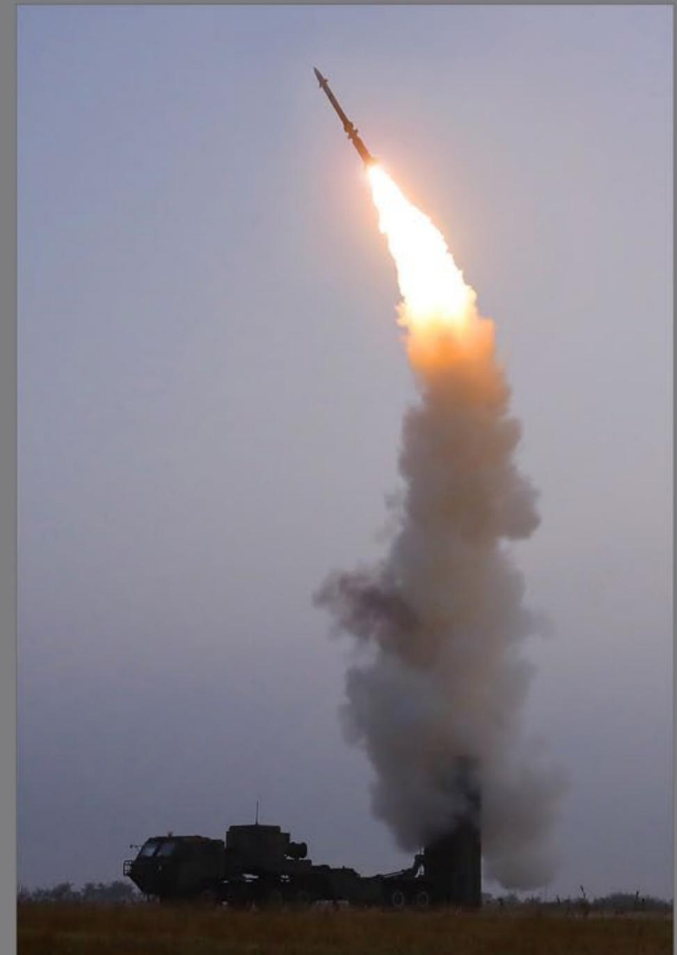
**30** сентября произведен испытательный запуск новой противоздушной ракеты, разработанной в Академии национальной обороны. Цель – подтвердить боевые характеристики новой ракеты, а также применимость пусковой установки, радиолокатора и управляющего комплекса.
