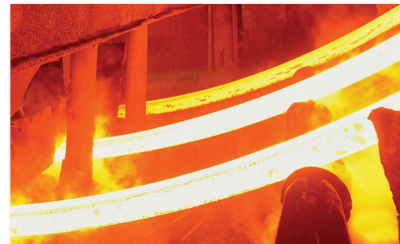
Процесс непрерывной разливки.
