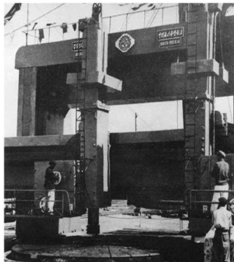
Рабочий коллектив Рёнсонского машиностроительного завода завершает сборку карусельного станка с планшайбой диаметром 8 м.
